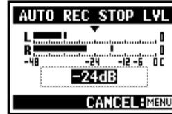
Stellen Sie den Aufnahmepegel so ein, dass ein automatisches Stop-Signal anliegt.
